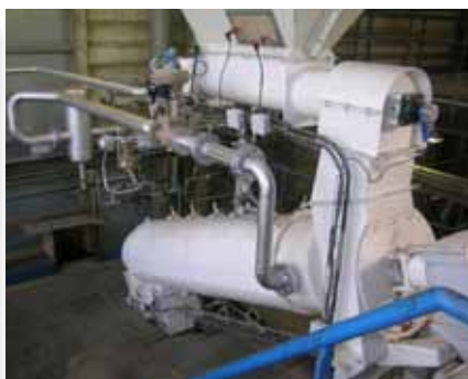
Super conditionneur avec injection de vapeur
