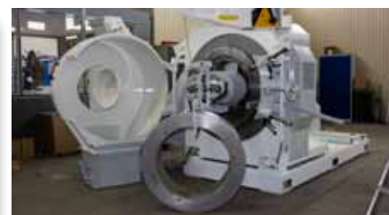
Treuil intégré pour manutention de la filière
