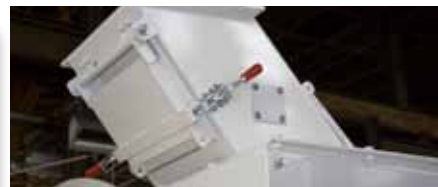
Plaque magnétique sur goulotte d'alimentation
