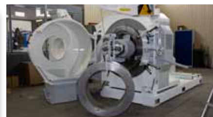
Treuil intégré pour manutention de la filière
