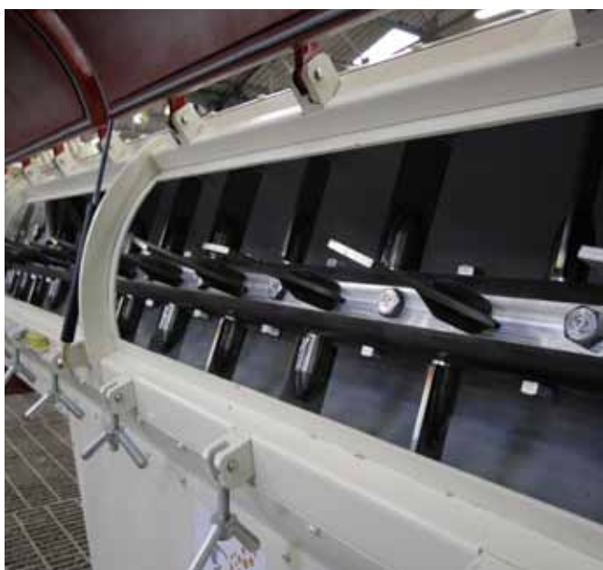
Rotor et palettes du conditionneur horizontal longue durée
