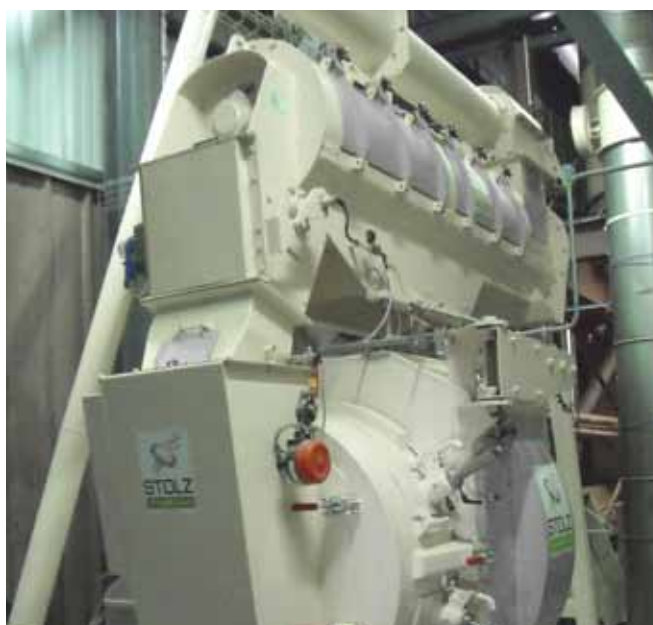
Conditionneur horizontal longue durée sur presse à granuler
