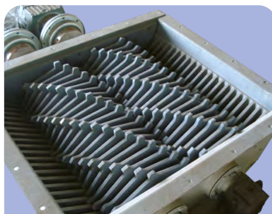
Brise mottes à double rotor avec denture spéciale
